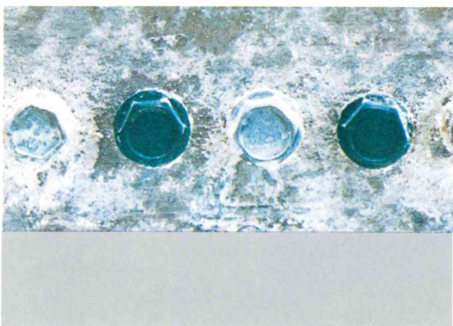
《アルミニウム板に穴を開けて、試験片(ボルト)を締めつけたもの》
